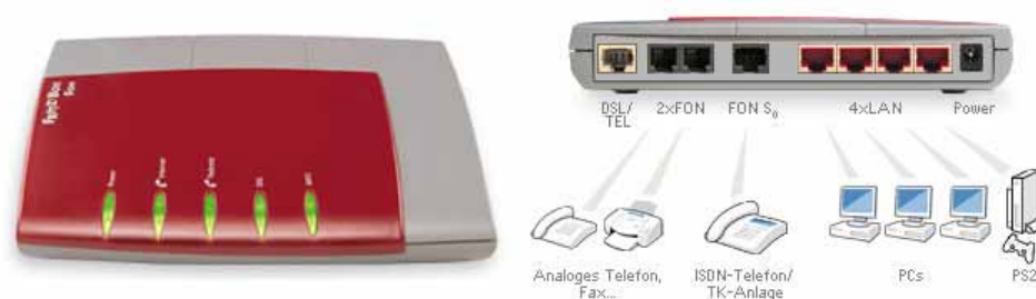
Abbildung 2: Fritz!Box Fon von AVM. Beispiel für ein DSL-Router mit VoIP-Unterstützung
